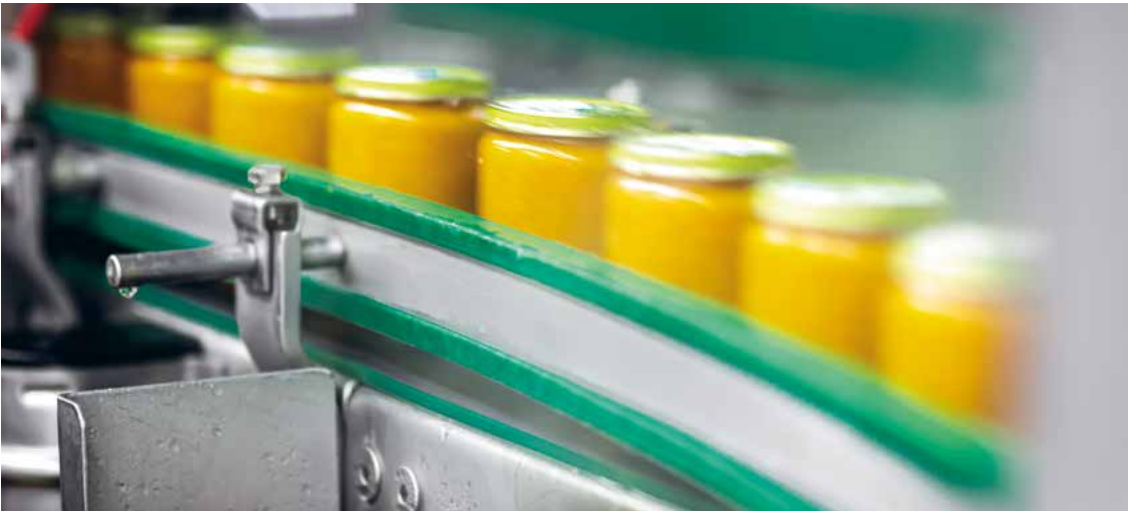
Die Glaswand der HiPP Gläschen ist so dünn wie möglich und so dick wie nötig, um den hohen Beanspruchungen wie hier im Produktionsverlauf und beim anschließenden Transport Stand zu halten.
