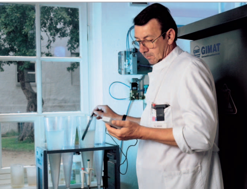
Keine Abwasserbelastung: Auch die Abwässer werden bei HiPP kontrolliert. Alfred Wille misst den pH-Wert, bevor das Abwasser in die Kläranlage eingeleitet wird.
